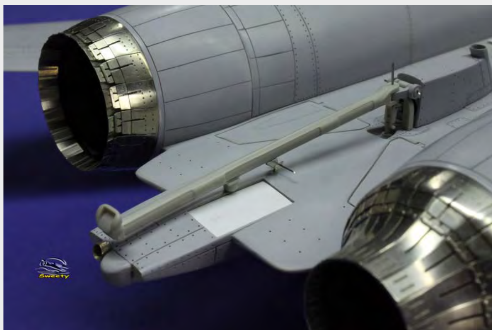
Bricolage du tuyau de vide-vite, laiton tourné et soudé sur de la photodec.
